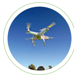
无人机 (机身、螺旋桨、地面支架、起落架)
